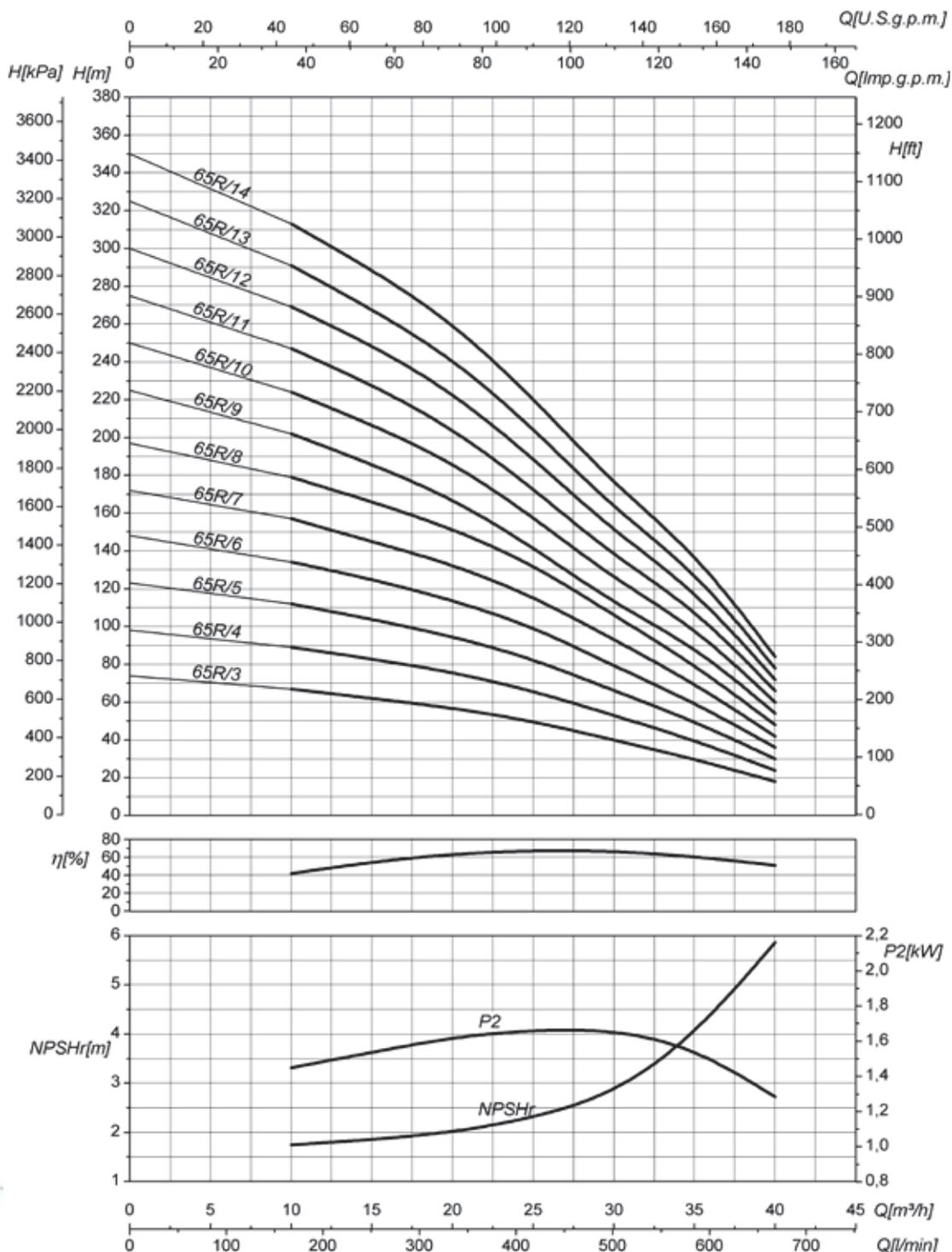
Moltiplicare il rendimento per il coefficiente corrispondente al vostro numero di stadi • Multiply efficiency by the coefficient corresponding the number of stages. • Multiplicar el rendimiento por el coeficiente correspondiente a su numero de etapas. • Multiplier le rendement par le coefficient correspondant à votre nombre d'étages. • Необходимо умножить КПД на коэффициент согласно количеству ступеней Вами выбранного насоса. • Das Wirkungsgrad mit dem der Stufenzahl entsprechenden.
