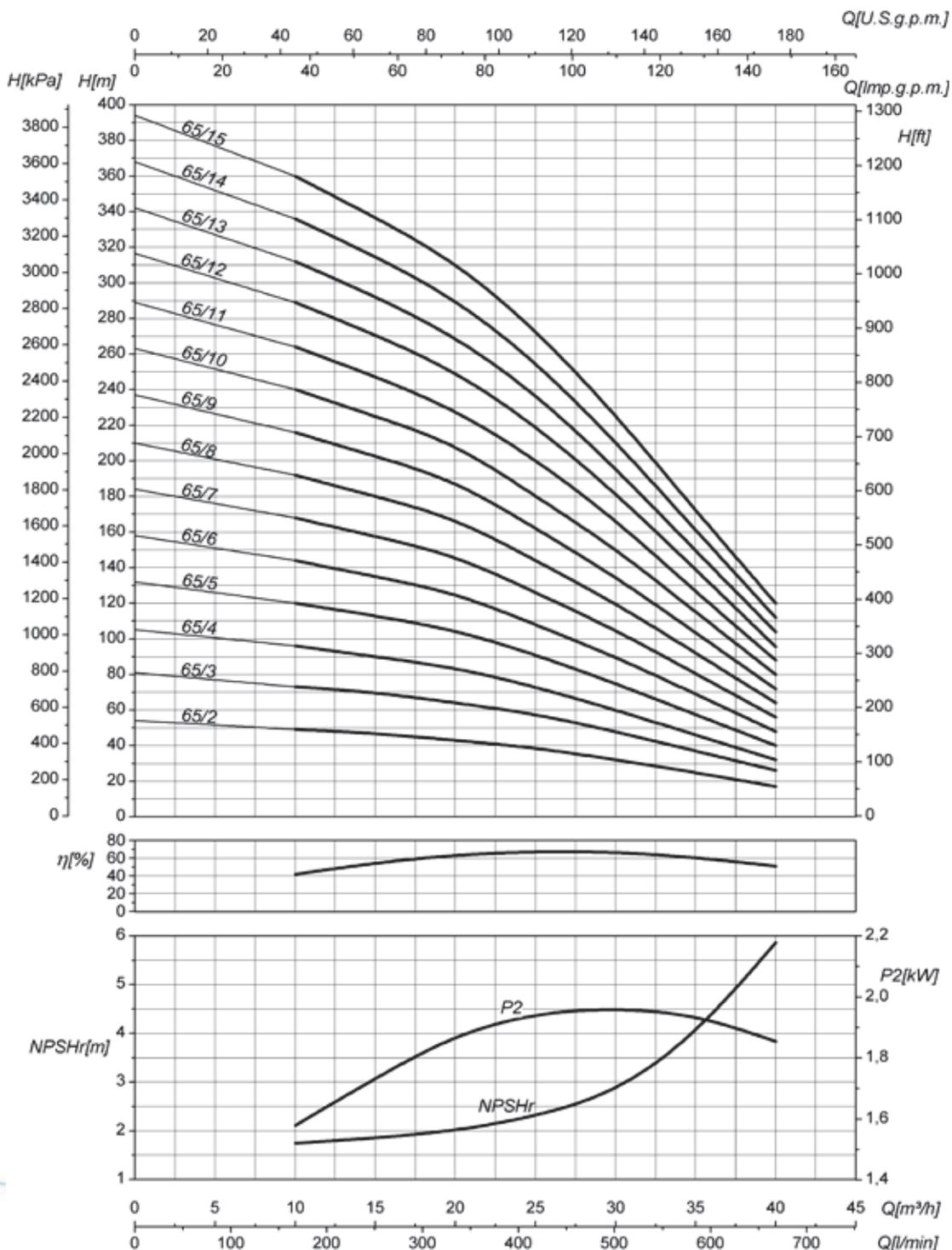
Moltiplicare il rendimento per il coefficiente corrispondente al vostro numero di stadi • Multiply efficiency by the coefficient corresponding the number of stages. • Multiplicar el rendimiento por el coeficiente correspondiente a su numero de etapas. • Multiplier le rendement par le coefficient correspondant à votre nombre d'étages. • Необходимо умножить КПД на коэффициент согласно количеству ступеней Вашего выбранного насоса. • Das Wirkungsrad mit dem der Stufenzahl entsprechenden.
